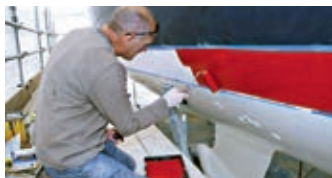
Aplicación en la línea de flotación
